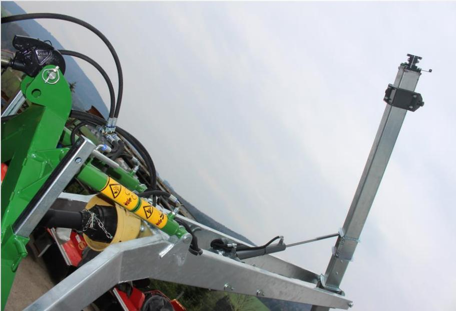
Mittels einer **halbautomatischen Kupplung und Verriegelung** kann die Rührstange bequem vom Traktor aus in die Grubenöffnung eingefädelt werden!
